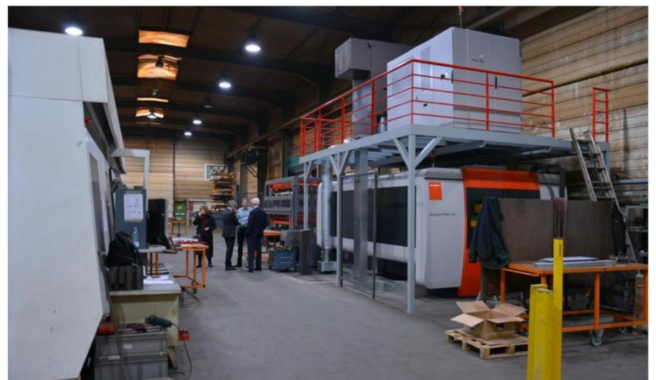
Une machine de 14 mètres de long, avec un système de chargement et déchargement automatique des tôles et des pièces. PHOTO DNA - ANNE MULLER
